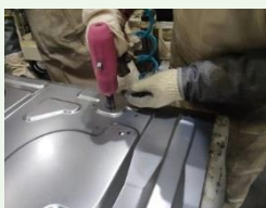
定扭电枪代替冲击式 风动扳手
