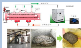
污泥干化技术减量260吨/年
